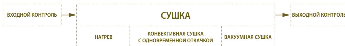
**Рис. 3. Технологическая схема процесса сушки**
