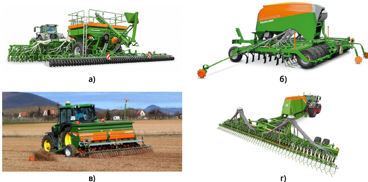
Рис. 11. Сеялки АО «Евротехника»: а) DMC ...; б) Сауена ... (долотовидные сошники); в) D-9; г) Citan шириной захвата от 9 до 15 м для посева зерновых (дисковые сошники)
