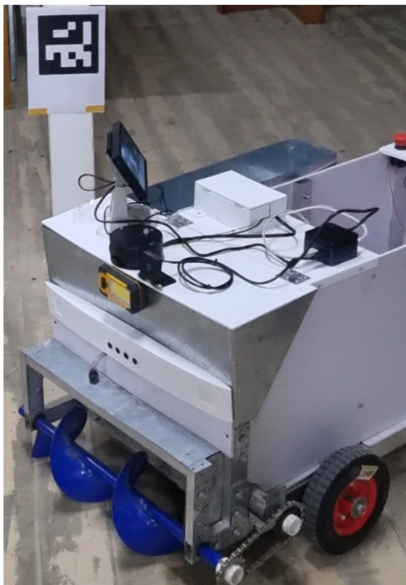
Рис. 3. Тестирование системы управления прототипа мобильного робота
